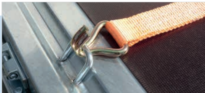
Kotvící zajišťovací prvky v bočním podlahovém profilu
