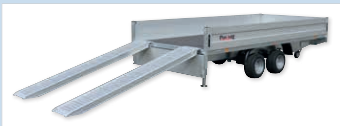
Hliníkové nájezdy (jen pro provedení se zadními podpěrami)
