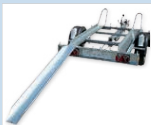
2 vodící lyžiny a 1 nájezdová lyžina s nízkým nájezdovým úhlem
