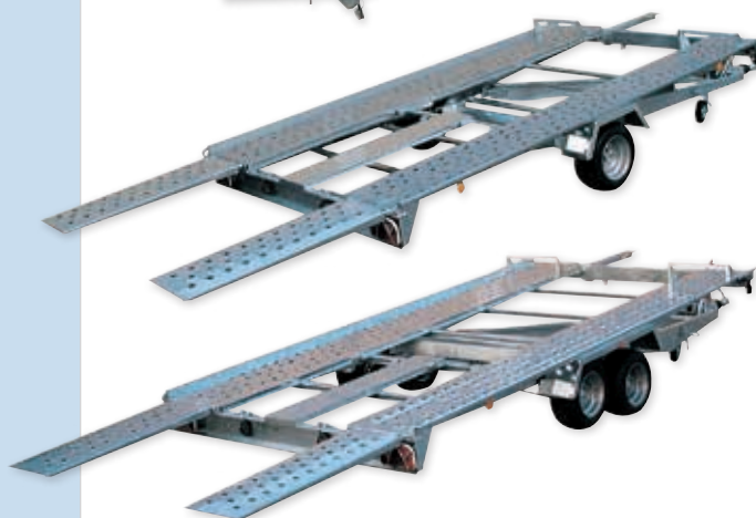
Stavitelné a posuvné dorazy kol, držák navijáku a držák rezervy
