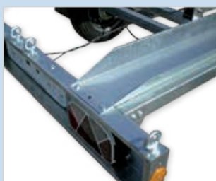
8 kotvicích ok na rámu přívěsu k zajištění přepravovaného motocyklu
